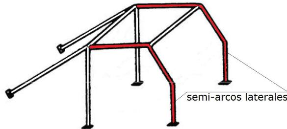
x) Puntal o miembro longitudinal superior: tubo recto casi-longitudinal que une a la altura del techo al arco principal con el arco frontal. Sus extremos se vinculan a los arcos en las esquinas de estos últimos, o a no más de 100mm de estas esquinas.
