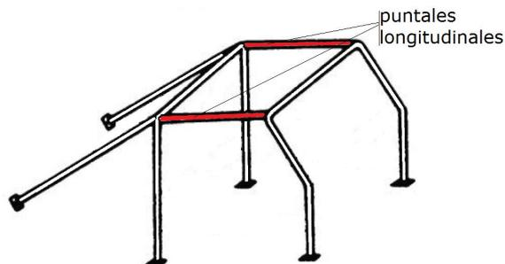
xi) Puntal o miembro transversal superior: tubo recto transversal que une a la altura del techo a ambos arcos laterales o a ambos semi-arcos laterales. Sus extremos se vinculan a los arcos en las esquinas de estos últimos, o a no más de 100mm de estas esquinas.
